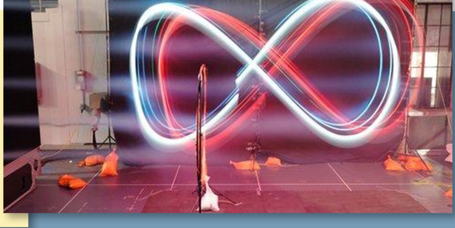
Dron equipado con Neural-Fly manteniendo un rumbo en forma de ocho en medio de fuertes vientos en el túnel de viento de clima real de Caltech
