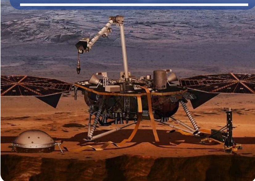
Módulo de aterrizaje InSight Martian con un instrumento SEIS desplegado. (NASA/JPL-Caltech)
